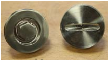
Parafuso de travamento para abrir com uma ferramenta convencional
