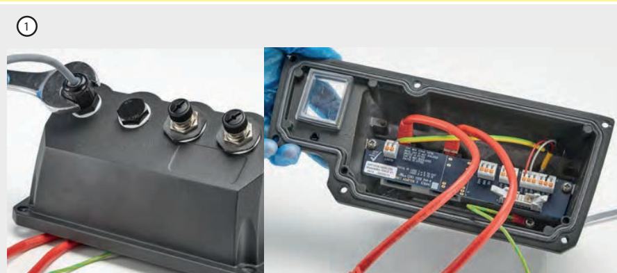
Figur 10 - Jordskärmning av styrkablar på EtherNet/IP™ NEMA-modul
