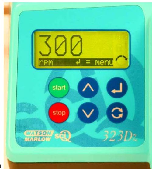
alta velocità). Se la pompa è in funzione quando si preme il tasto **GIÙ**, il cambiamento avviene immediatamente.
