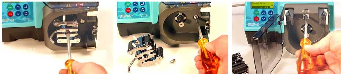
Il rotore serra l'albero di azionamento tramite un un collare diviso. Per smontare il rotore, tenerlo ben fermo e togliere la vite di fissaggio centrale del rotore.
