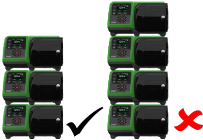
GF:图 1 -泵堆叠
