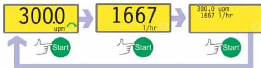
Falls die Pumpe läuft, wenn die Taste **START** gedrückt wird, wechseln die Angaben im Handbedienungs-Hauptbildschirm von Umdrehungen pro Minute zu Fördermenge in verschiedenen Maßeinheiten (über einen Warnbildschirm, falls die Fördermenge nicht kalibriert wurde und dies der erste Arbeitszyklus seit dem Einschalten ist) und schließlich zu Umdrehungen und Fördermenge. (Siehe Beispiel.) Die Standardeinstellung kann über das Setupmenü (siehe 16.3 *Anzeige*) geändert werden.
