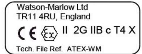
Wenn Kunden Pumpen ausschließlich in einem Umfeld der Explosionsgruppe IIA mit explosionsfähigen Atmosphären aus Gasen verwenden und keine Trockenlaufsicherung integriert wurde, muss der Betreiber die Pumpe mit dem nachfolgenden Typenschild, das mit diesem Handbuch geliefert wird, neu kennzeichnen.
