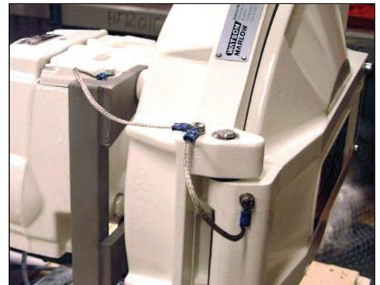
Elektrostatische Tests haben ergeben, dass die Pumpe bei Verwendung mit Bioprene Schlauchelementen von Watson-Marlow in den für diese Pumpe vorgesehenen Abmessungen den Anforderungen von ATEX II2G c IIB T4 X entspricht. Das X weist darauf hin, dass spezielle Hinweise zu beachten sind.
