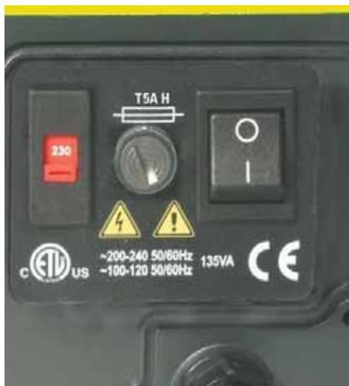
**Fusibili di protezione sulla linea di ingresso:** fusibile a cartuccia ad azione ritardata tipo T5A H 250 V 20 mm, situato in un portafusibili al centro del quadro interruttori nella parte posteriore della pompa.
