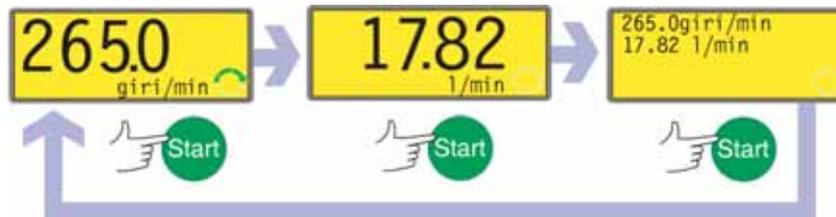
Se la pompa è in funzione quando si preme il tasto **START**, le informazioni indicate sulla schermata principale della modalità manuale passano dai giri al minuto alla portata in una scelta di unità (passando per una schermata di avvertenza se la portata non è stata tarata e se questo è il primo ciclo dall'accensione), ai giri/min, alla portata e al tempo di lavoro. Qui è riportato un esempio. La regolazione predefinita può essere modificata tramite il menu Imposta (vedere 16.3 Display).
