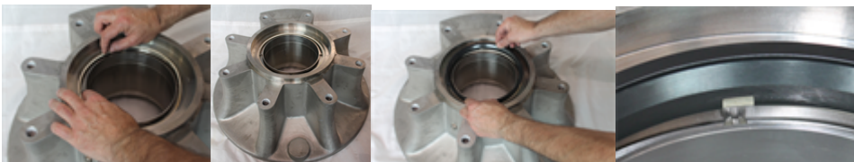
Ensemble de ressorts correctement assemblé au dos du corps de pompe arrière.
