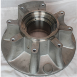
Dos du corps de pompe arrière montrant où l'assemblage du joint arrière du système de double joint mécanique sera installé.
