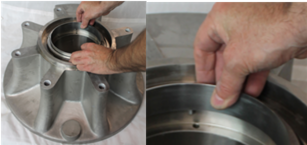
Ensemble de ressorts correctement assemblé au dos du corps de pompe arrière.
