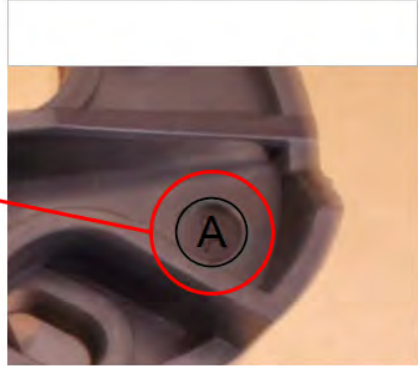
En ATEX-rotor är märkt med "A" i positionen som visas
