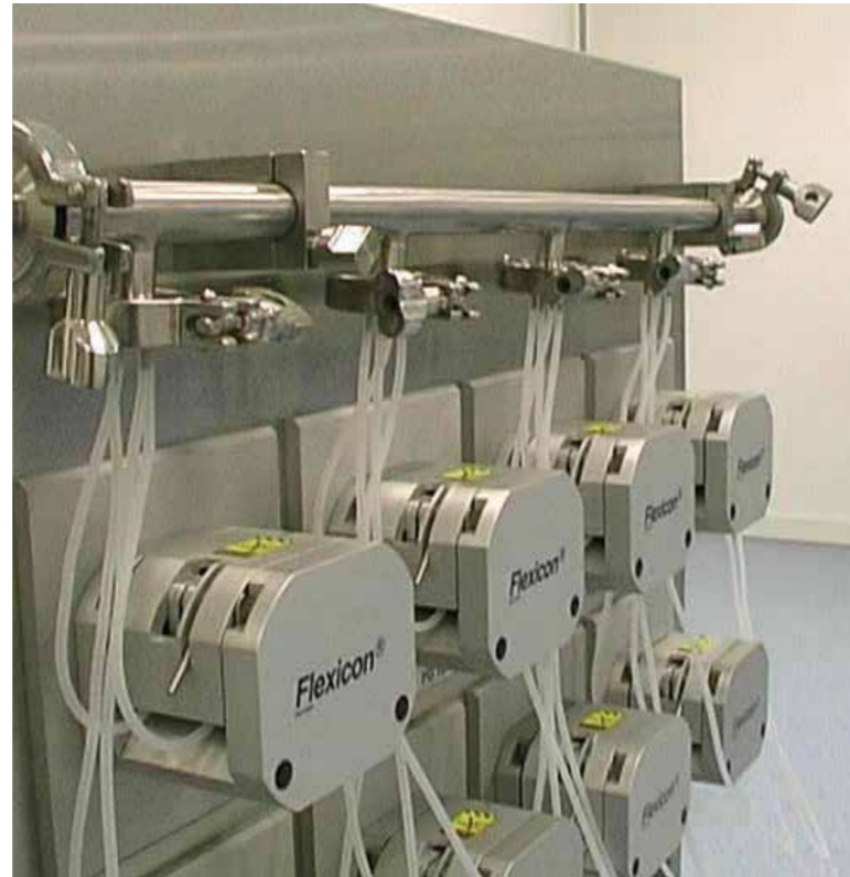
Trolley-Lösungen zur Integration in neue oder vorhandene Abfülllinien mit bis zu sechzehn Schlauchpumpen
