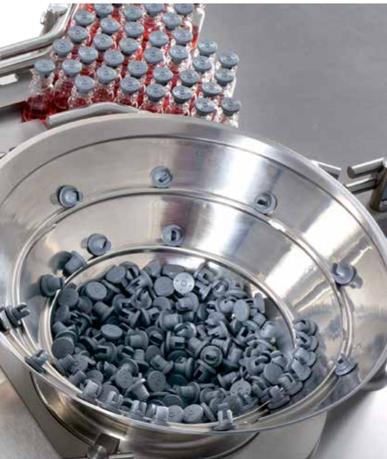
13mm 및 20mm 스톱퍼를 사용한 스톱퍼링에는 추가 포맷 파트가 필요 없음
