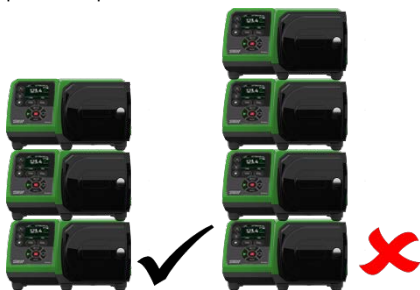
Figure 2 - Empilement de pompes
