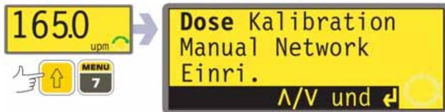
Das Hauptmenü bietet fünf Optionen: **Dose (Dosierung)**, **Kalibration (Kalibrierung)**, **Manual (Handbedienung)**, **Setup (Einrichtung)** und **Network (Netzwerk)**. Verwenden Sie die Tasten **AUF** und **AB**, um eine Auswahl zu treffen. Drücken Sie die Taste **ENTER**, um die Auswahl zu bestätigen.
