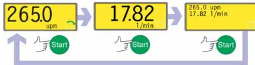
Falls die Pumpe läuft, wenn die Taste **START** gedrückt wird, wechseln die Angaben im Handbedienungs-Hauptbildschirm von Umdrehungen pro Minute zu Fördermenge in verschiedenen Maßeinheiten (mit einem Warnbildschirm, falls die Fördermenge nicht kalibriert wurde und dies der erste Arbeitszyklus seit dem Einschalten ist) und schließlich zu Umdrehungen und Fördermenge. (Siehe Beispiel.) Die Standardeinstellung kann über das Setupmenü (siehe 19.2 Anzeige) geändert werden.
