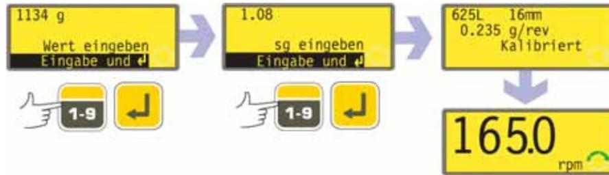
**Hinweis:** Wenn die Pumpe so eingestellt ist, dass sie die Fördermenge in Einheiten der Masse (siehe 18.8 Fördermenge-Maßeinheiten) anzeigt, wie es in diesem Beispiel der Fall ist, wird ein Bildschirm angezeigt, in dem Sie die relative Dichte des geförderten Mediums bestätigen können, bevor Sie abschließend die Taste **ENTER** drücken.
