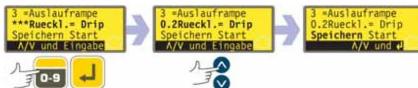
Die Pumpe kann so eingestellt werden, dass sie nach Beendigung einer Dosierung kurzzeitig rückwärtsläuft, damit keine zusätzlichen Tropfen der Flüssigkeit nachlaufen können.
