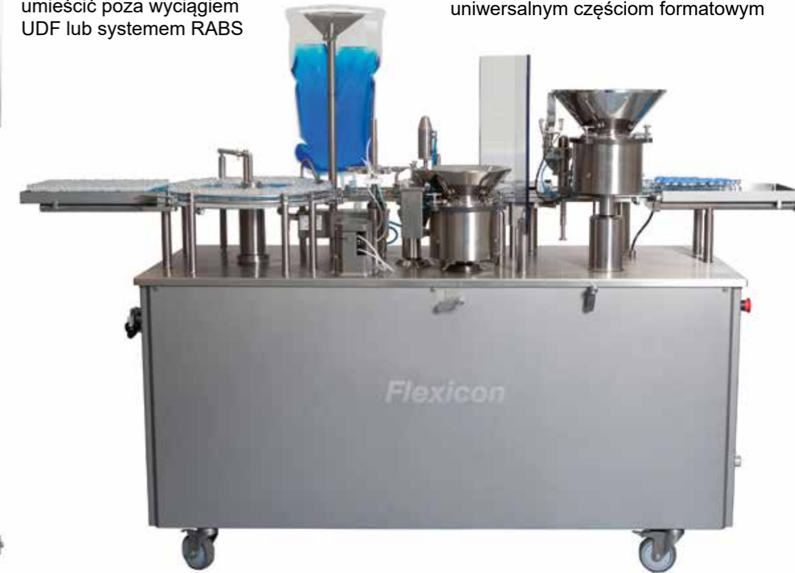
Napełnianie, korkowanie i zakręcanie wielu różnych rodzajów fiolek dzięki uniwersalnym częściom formatowym
