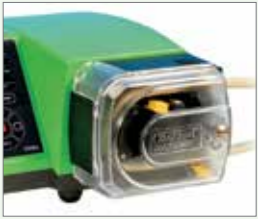
520R/520R2 최대 2bar 압력과 최대 3.5L/min 유량에 대한 연속 튜브 펌프헤드
