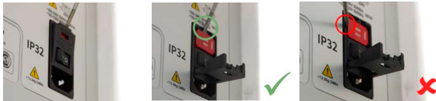
図57 - フューズホルダの取り外し方
