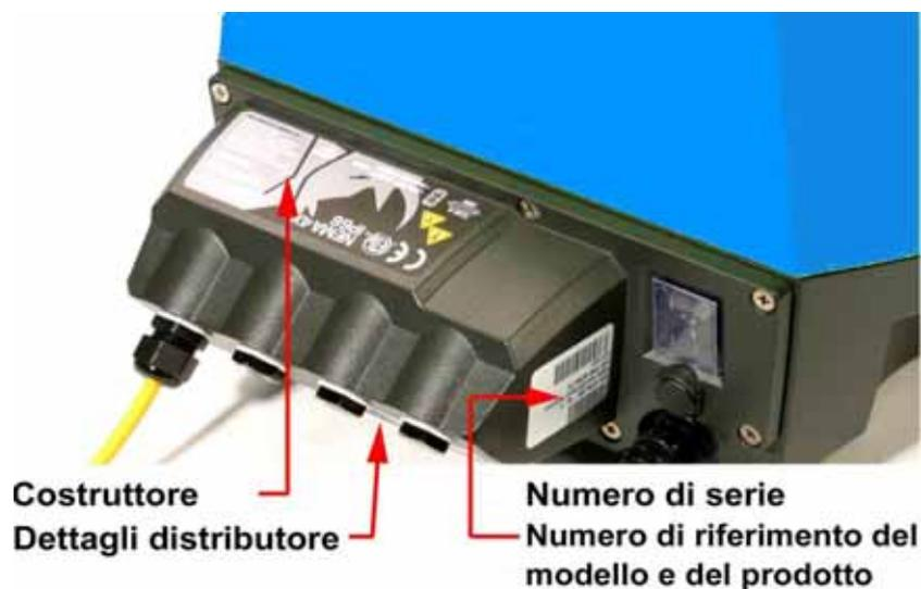
Le stesse informazioni si trovano sul quadro interruttori dell'unità di azionamento, accessibile dopo lo smontaggio del modulo 720N. Il numero dei connettori varia a seconda del modello.
