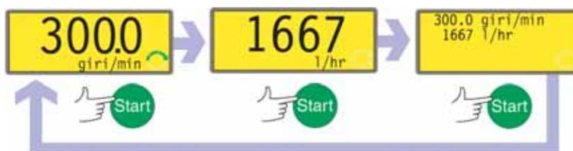
Se la pompa è in funzione quando si preme il tasto **START**, le informazioni indicate sulla schermata principale della modalità manuale passano dai giri al minuto alla portata in una scelta di unità (con la visualizzazione di una schermata di avvertenza se la portata non è stata tarata e se questo è il primo ciclo dall'accensione), ai giri al minuto e alla portata. Qui è riportato un esempio. La regolazione predefinita può essere modificata tramite il menu Imposta (vedere 16.3 Display).
