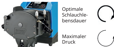
Figure 3 - Drehrichtung des Rotors
