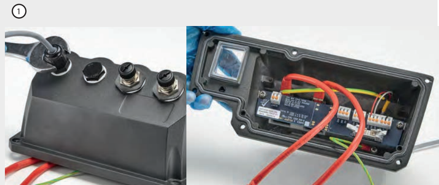
Figure 10 - Erdungsschirmung der Steuerleitungen am EtherNet/IP™ NEMA-Modul
