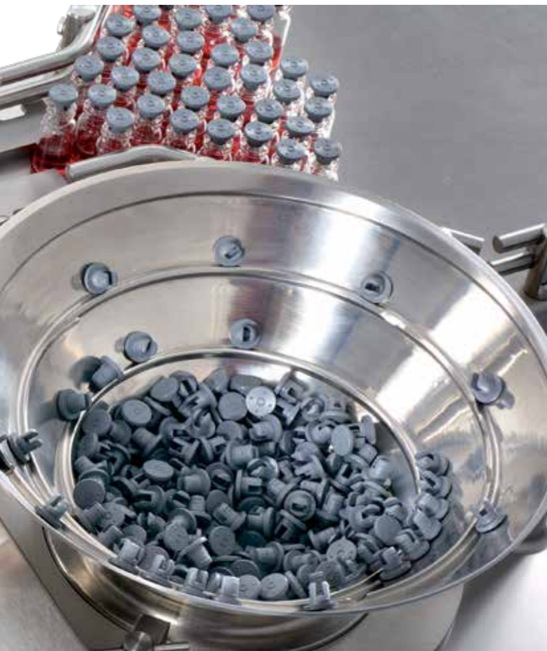
La tappatura con tappi da 13 mm e 20 mm non richiede parti di formato diverso supplementari
