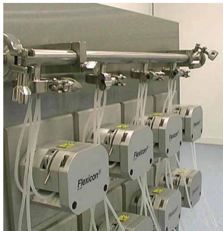
Le soluzioni trolley vengono fornite per l'integrazione in linee di riempimento nuove o esistenti con un massimo di 16 riempitrici peristaltiche
