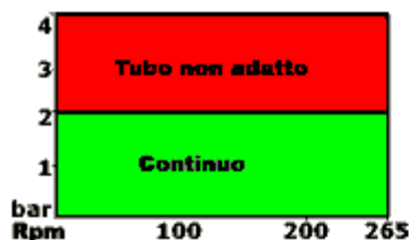
Marprene, Bioprene, Silicone, Neoprene - fino a un diametro interno di 15,9mm
