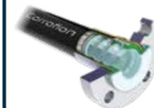
El revestimiento interno de PTFE en la manguera Corroflon posee circunvoluciones superficiales que minimizan la limitación del caudal; además, un alambre externo de refuerzo colocado en las circunvoluciones externas ofrece una resistencia plena al vacío y a las torceduras
