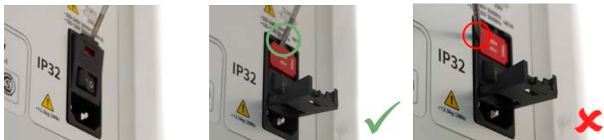
rys. 57 - Jak zdjąć oprawkę bezpiecznika
