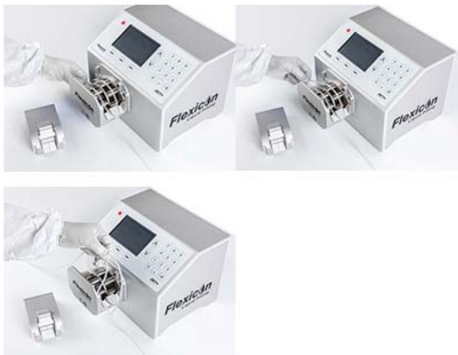
rys. 8 - Wyjmowanie węża z głowicy pompy
