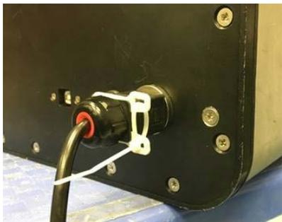
Prima di alimentare l'unità, assicurarsi che la clip di sicurezza sia perfettamente fissata al connettore di potenza applicando una fascetta stringicavo (come illustrato) e che il connettore Harting sia ben posizionato.
