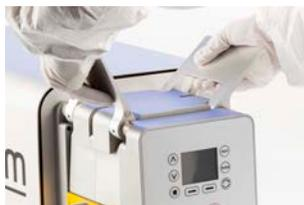
Sollevare le maniglie di bloccaggio del corpo della pompa Quantum.
