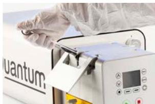
Utilizzando la chiave fornita, liberare le maniglie di bloccaggio del corpo della pompa Quantum dalla relativa testa.
