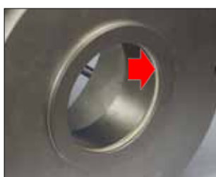
O-ring corpo pompa
