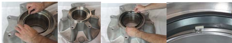
Pacco molle correttamente assemblato sul retro dell'alloggiamento posteriore.
