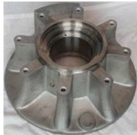
Retro dell'alloggiamento posteriore con l'indicazione della posizione in cui dovrà essere installato l'insieme della guarnizione posteriore del sistema di tenuta meccanica doppia.
