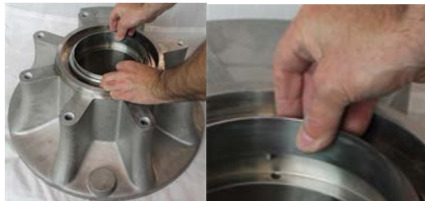
Pacco molle correttamente assemblato sul retro dell'alloggiamento posteriore.
