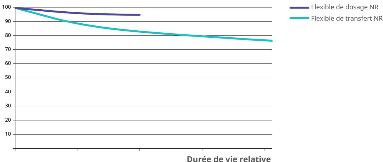
Conditions de test de performance standard : pompage d'eau à 18 °C (64 °F) à 5 bars (73 psi) et 50 tr/min.
