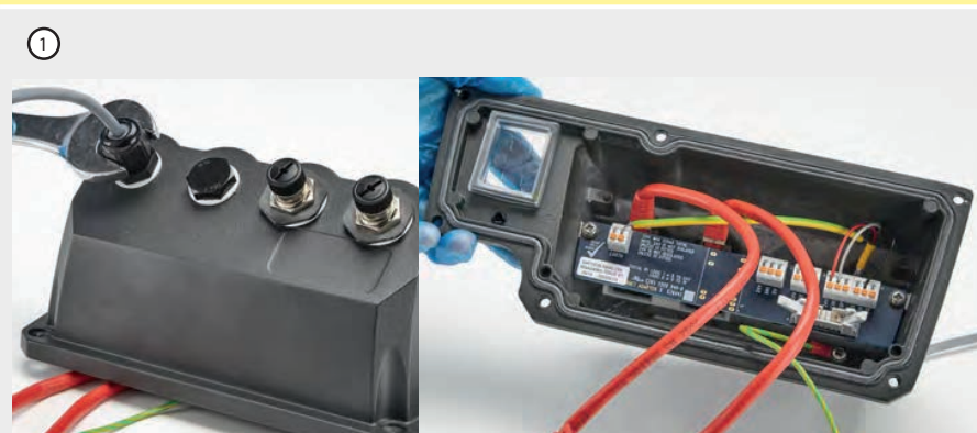
Figure 10 - Jordskærmning af styrekabler på EtherNet/IP™ NEMA-modul
