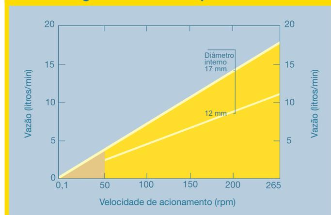
■ Limitado a 2 bar abaixo de 50 rpm A vazão varia conforme o material da mangueira, a pressão de descarga, a sucção e a viscosidade
