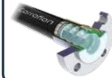
Il rinforzo interno teflonato in Corroflon ha delle leggere circonvoluzioni che riducono al minimo la restrizione delle portate, mentre il filo metallico di rinforzo esterno offre una totale resistenza al vuoto e alle piegature.
